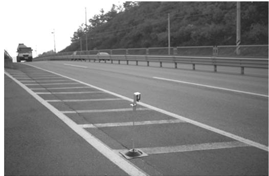
그림 12 실제 측정 센서 설치(2차로 고속국도)
